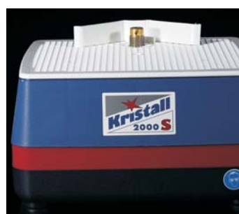
30 101 50 Schleifmaschine KRISTALL 2000S Grinder KRISTALL 2000S Arbeitsfläche 280 x 235 mm work surface, 2800 U/min / 2800 rpm 230/240V / 50Hz / 100 W, Präzisionskugellager / dual precision ball bearings, eingebaute Schleifwasserpumpe / built in grinding waterpump, Thermoschutz / thermal protection, Spritzschutz / splash guard und 19 mm Schleifkopf / diamond bit
